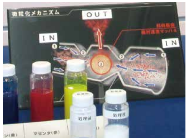
原料同士をマッハ4の相対速度で衝突させる超微粒化技術
